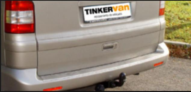
**Bola de remolque:** El accesorio indispensable para poder remolcar o anclar accesorios como porta bicicletas, con el nuevo sistema de enganche de 13 pins.
